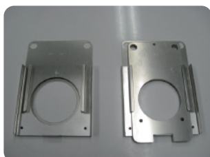
左：アイリスゲート用ホルダ 右：日本製ステンレス用ホルダを取り付けた状態
