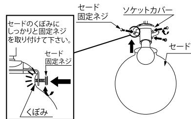
**△** ネジを固定した後に再度、セードがしっかりと固定されているか確認してください。
