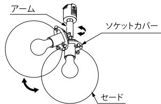
**○** セード破損の恐れがありますのでセードを持って可動させないで下さい。
