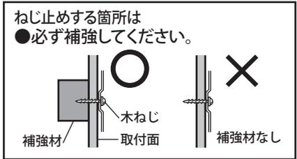
ねじ止める箇所は ●必ず補強してください。
