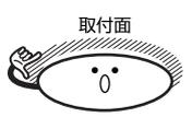
取付面の温度は90℃を超えないように設計されていますが、空気流通が悪いとランプ熱による空気対流で周囲のほこりが取付面に付着し変色させることがあります。
