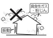
腐食性ガス・粉じんの影響を受ける場所、または振動の多い場所では使用しないでください。損傷、過熱、火災、感電、落下の原因になります。
