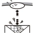
器具と被照射面の距離は本体表示および取扱説明書にしたがって十分な距離をとってください。指定距離より近すぎると、被照射物の変色・変質をおこすばかりか火災の原因になります。
