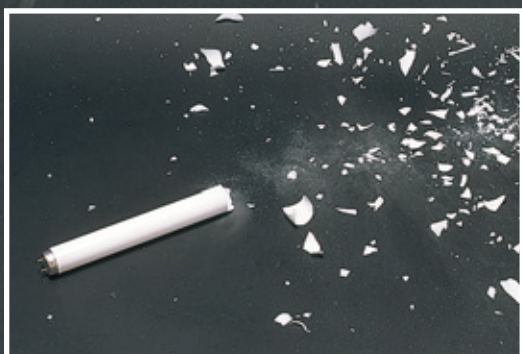
バンガード未装着蛍光管
