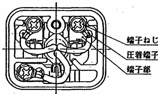
4-2-4 カバーを被せて組立ねじを0.5 N・m～0.8 N・mのトルクで締め付ける。
