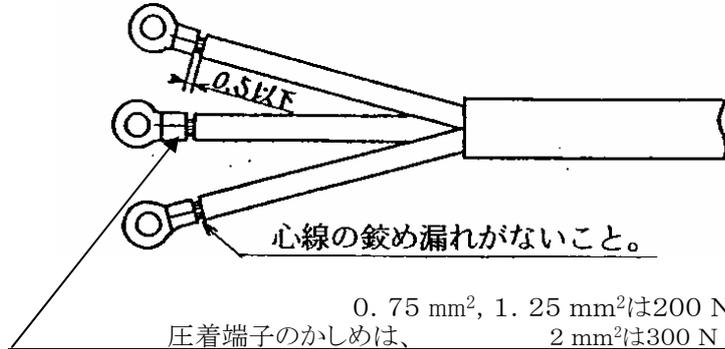
\*コード端末処理の寸法は、圧着端子に下記のものを使用した場合を示す。
